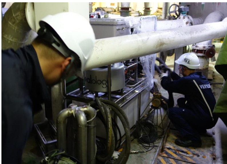
图 1. REALology 系统在南海某钻井现场实时监测泥浆性能设备部署情况
